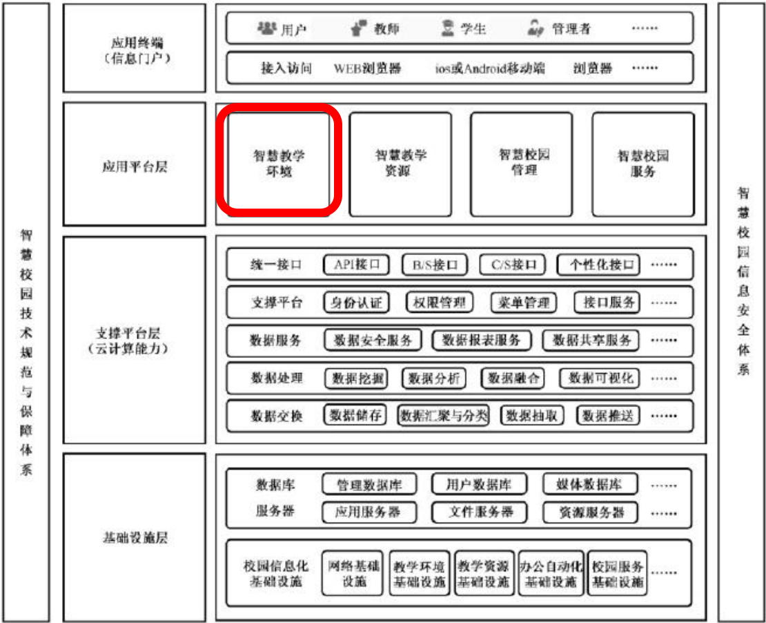
图 1 智慧校园总体架构图
